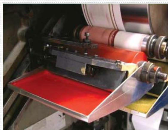
Limpieza de tintas en cilindros de flexografía
